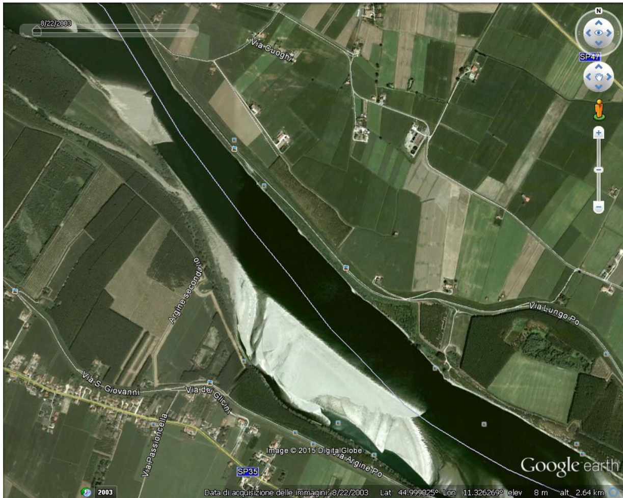
Figura 1. Foto satellitare tratta da Google Earth dell'anno 2003. Si noti che, precedentemente ai lavori degli anni 2004-2006 il corso di magra stazionava in sinistra idraulica per diversi chilometri mentre in destra, benchè in curva concava, emergeva una spiaggia.
