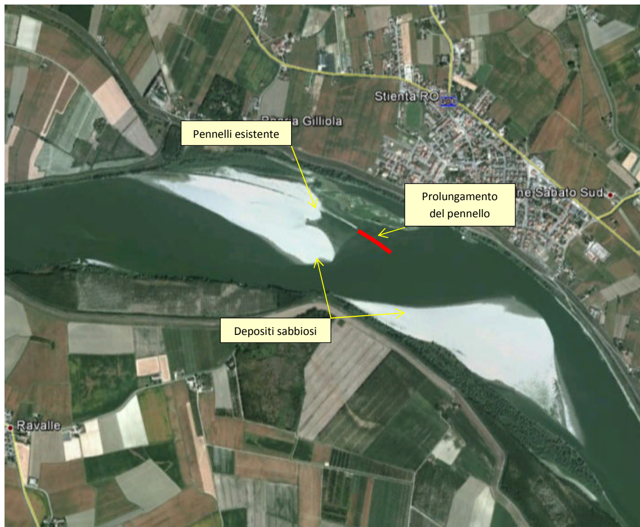
Figura 1. Quadro sinottico dell'assetto morfologico del corso d'acqua e degli interventi di regimazione a corrente libera previsti in corrispondenza dell'abitato di Stienta (RO).
