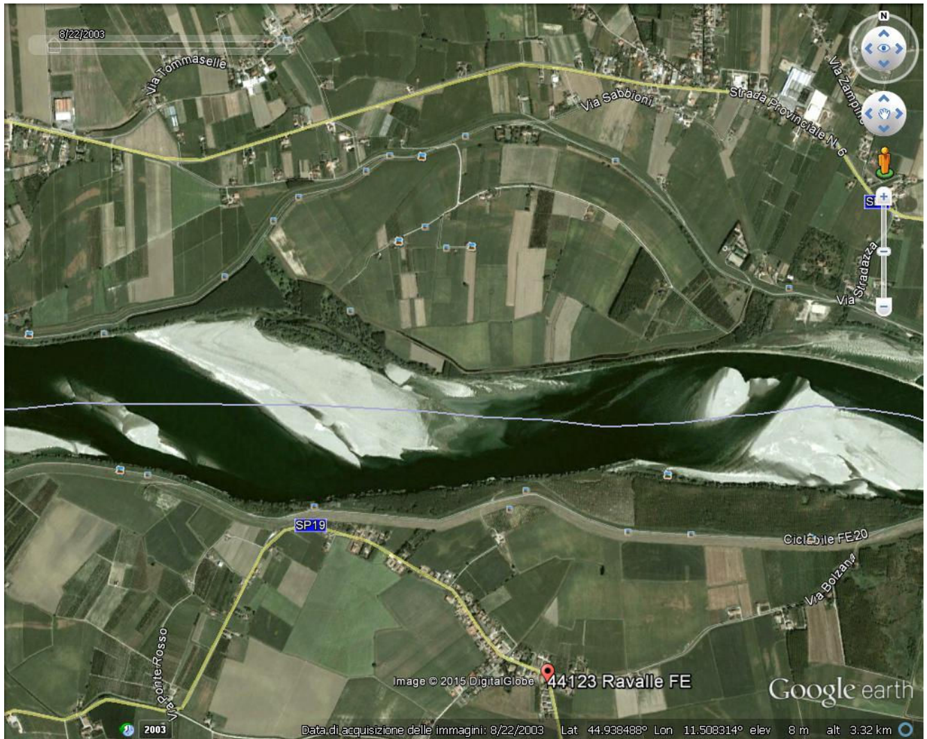
Figure 6 e 7. Confronto fra le foto satellitari tratte da Google Earth dell'anno 2003 e 2013. Condizioni idrologiche di basse portate e basse velocità della corrente. La corrente divaga con alto tasso di casualità nel tratto fluviale frontistante Ravalle, fra Gaiba e Stienta, mantenendo una preferenza per il percorso in destra. La predetta casualità nell'individuazione dei punti di battuta della corrente annulla l'efficacia delle opere di difesa esistenti.
