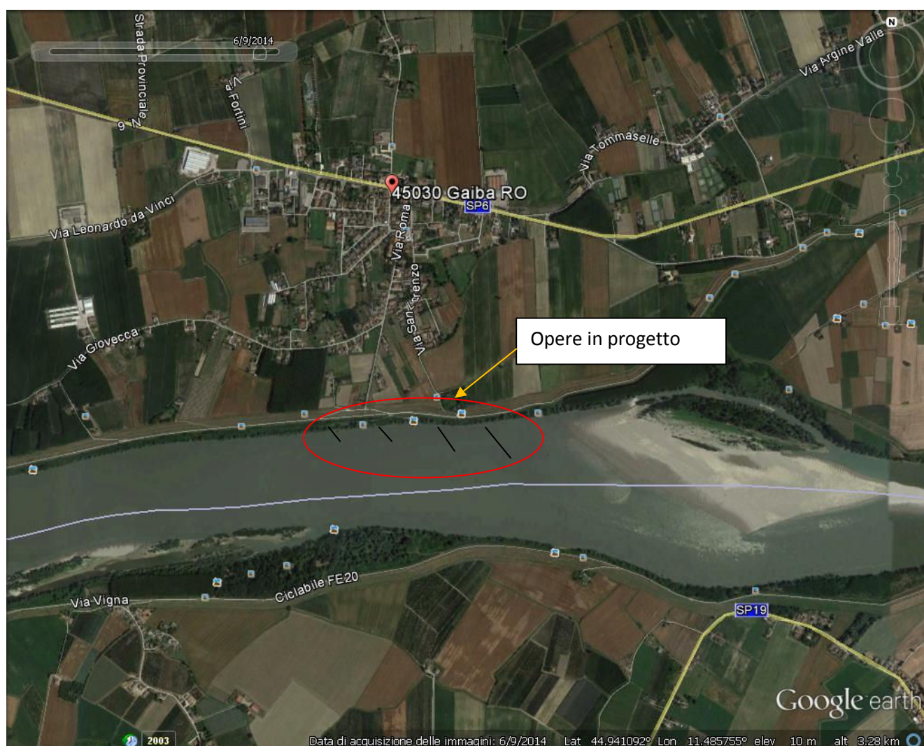
Figura 5. Foto satellitare tratta da Google Earth dell'anno 2014. Condizioni idrologiche di basse portate e basse velocità della corrente. L'allargamento dell'alveo immediatamente a valle di Gaiba genera un basso fondale per tutta la sezione trasversale; esso è preceduto da pericolose condizioni di erosione dell'argine in frodo..
